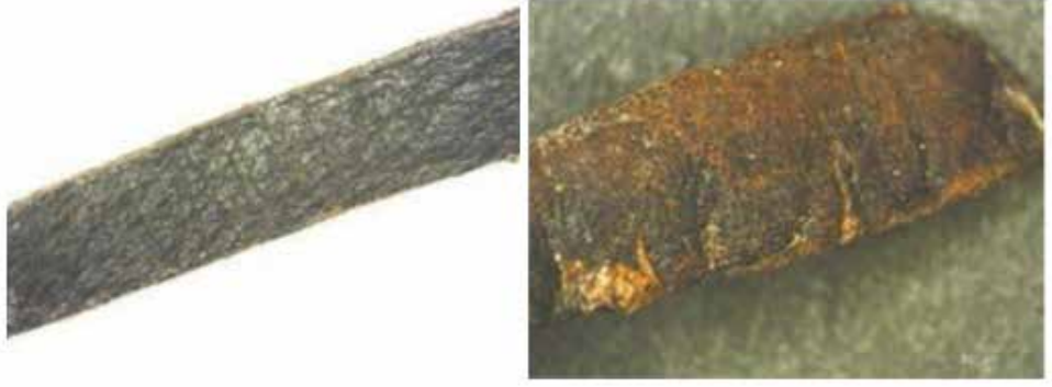
Şekil 7: Soldaki resim, Ribe ASR1843x76 c'den ayakkabı kordonu (10x büyütme). Tane deseni ID olmadan analiz edildi. Ayakkabı bağının gerçek genişliği yaklaşık 3-4 mm'dir. Sağ resim Odense OBM / 9776x5042a'dan ayakkabı 10x büyütme, tahıl analizi ile sığır olarak tanımlandı. Folikül delikleri nispeten eşit boyuttadır ve yüzeye düzenli olarak dağılmıştır. Bu üç boyutlu nesnenin yüzeyi kavisli, ufanmış, yırtılmıştır.
