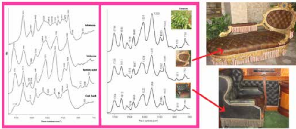
Şekil 9: ATR-FTIR spectra (1800-700 cm-1). Portekiz Kralı I. Luis'e (1861-1889) ait mobilyaların döşemelerinin kaplama malzemesi Fas derilerinin incelenmesi
