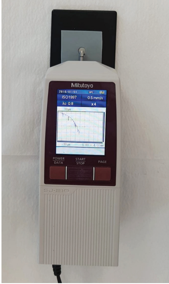
Şekil 1. Yüzeypürüzlülüğünün profilometre cihazı ile ölçülmesi
