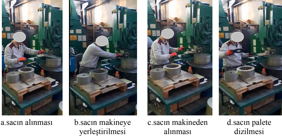
Şekil 2. Stator sac kesim işlem süreci.
