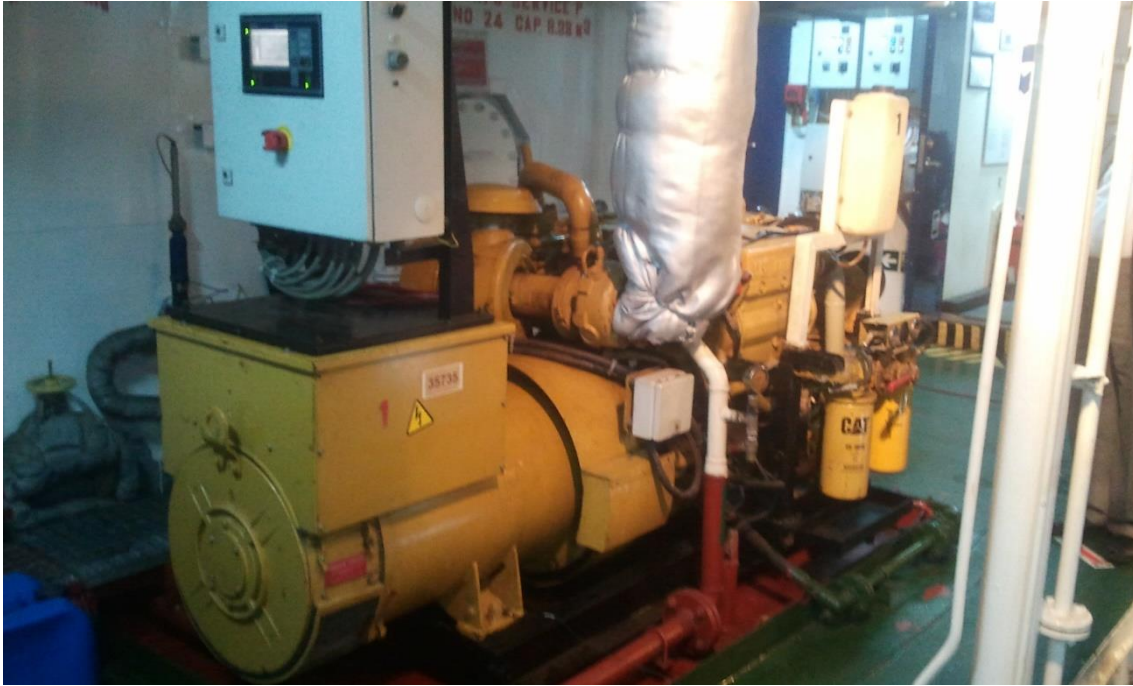
Şekil 1. Modal analizi yapılan gemi jeneratör seti.
