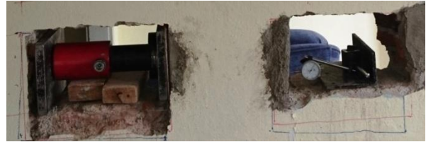
Şekil 2. Tuğla duvar itme-kesme deney düzeneği
