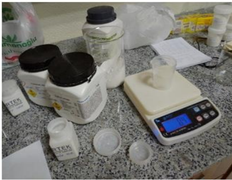
Şekil 3. Karışım Hazırlama Safhaları-I: (a) Bileşenlerin Uygun Kütlede Karıştırılması, (b) Karışımların Kül Fırınında Eritilmesi
