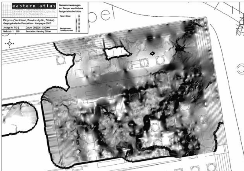
Abb. 15 Georadar- Untersuchungen unter dem 12- und 2- Säulensaal des jüngeren Didymaion: zerklüftete Felsformation mit Spuren anthropogene Abarbeitung
