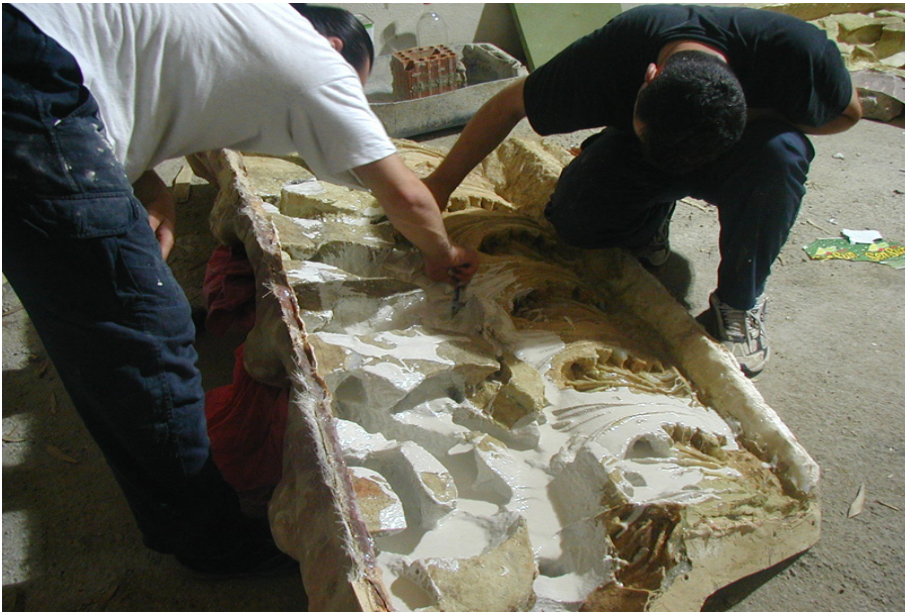
Fig. 12. Kalıba beyaz pigmentli döküm tipi polyester ile karıştırılan mermer tozunun dökülmesi.
