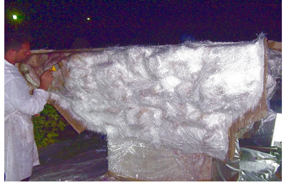
Fig. 9. Zarf kalıp yapımı.
