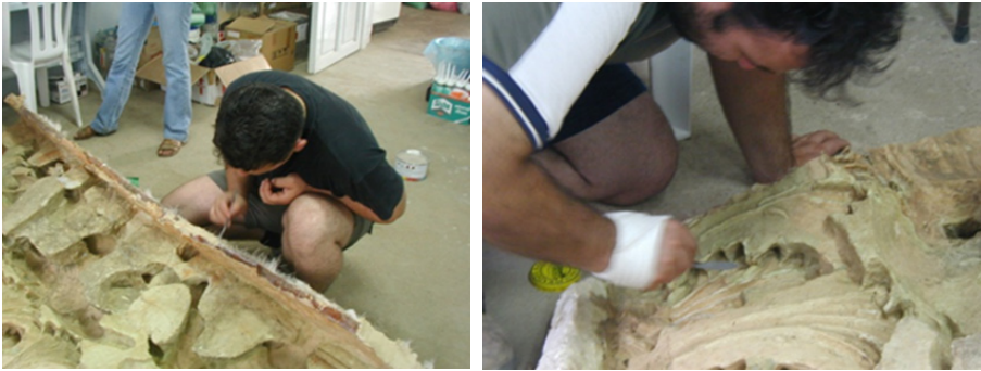
Fig.8. Solda kalıp açıldığında pasta silikonla yapılmış ayrışık onlarca iç maça, sağda palmet arkası içi boş birleşik jel silikonlar.
