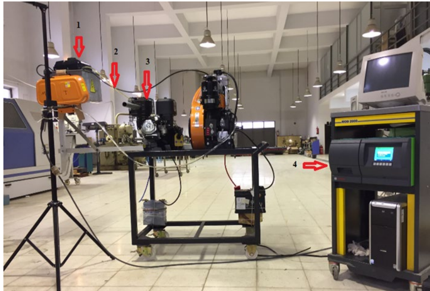
Şekil 6. Deney seti (1- Yakıt deposu 2- Yakıt hattı 3- Benzinli Motor 4- Egzoz emisyon cihazı)
