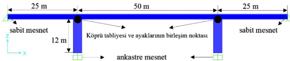
Şekil 1. Köprü modelinin x-z ekseninde görüntüsü, mesnet türleri ve eleman uzunlukları
