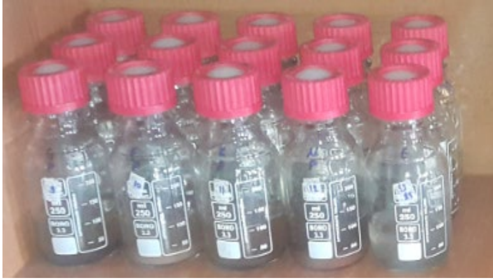
Şekil 3. Beş farklı pH'ta hazırlanmış fermantasyon reaktörleri
