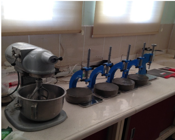
Şekil 1. SA Kullanılan Numunelerde Priz Süresi Tayini ve Farklı Noktalardan Ölçümler
