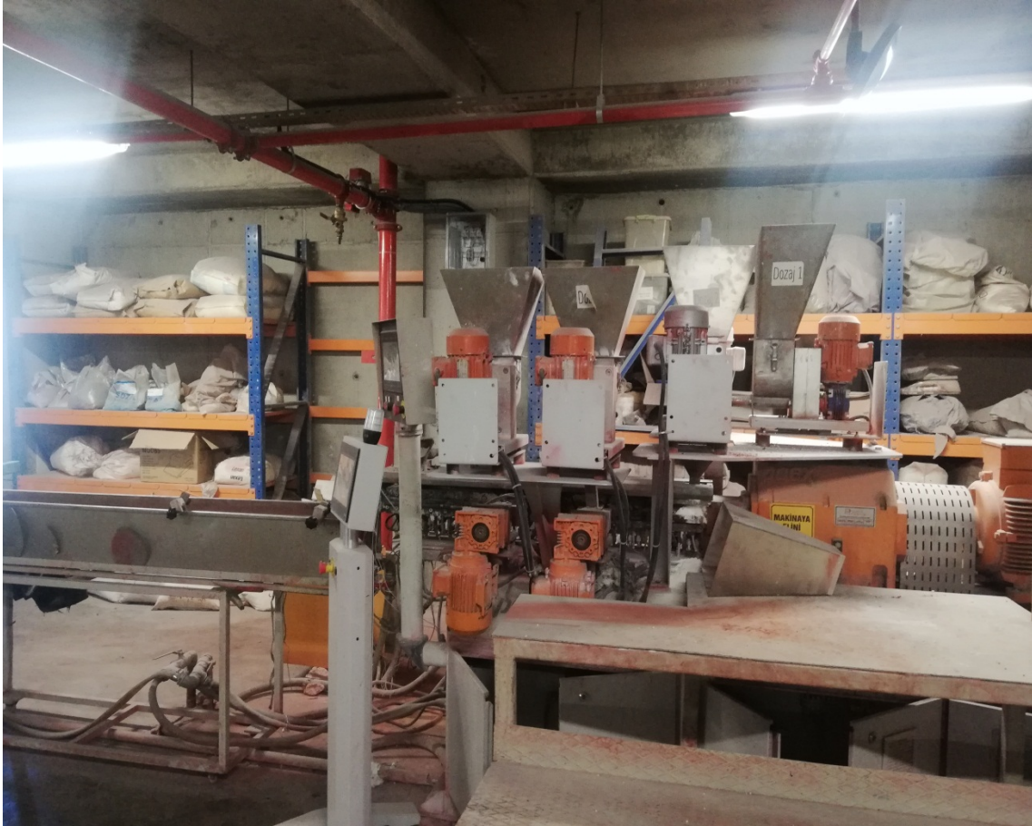
Şekil 4. Eriyik harmanlama tekniğine uygun çift vidalı ekstrüder hattı
