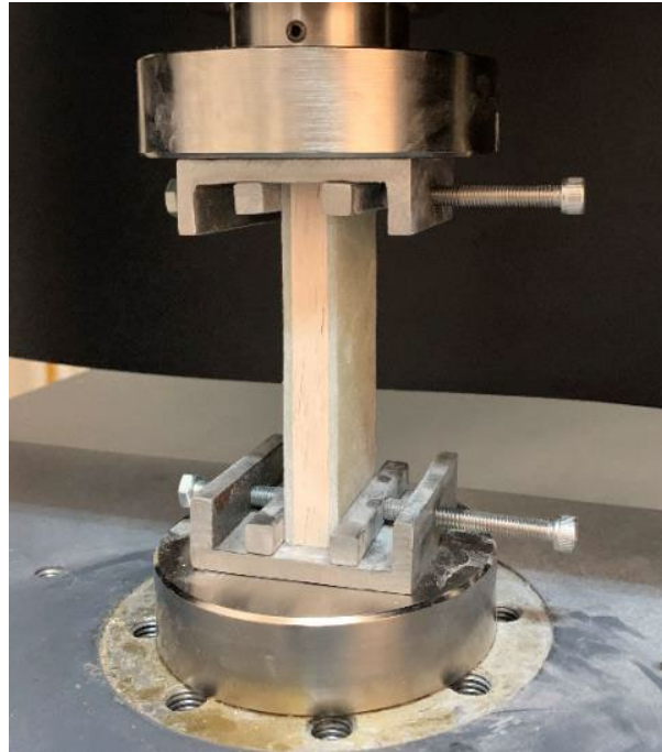
Şekil 1. Kenar basma test düzeneği.
