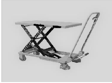
Şekil 4. Yüksekliği ayarlanabilir transpalet örneği.
