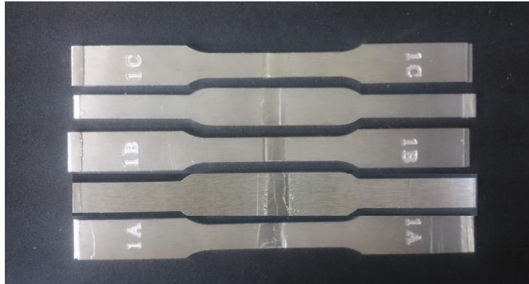
Şekil 4. Kaynaklı parçadan çıkartılan test numuneleri.
