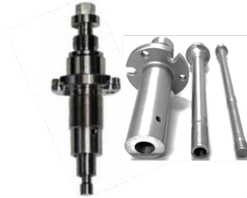
Şekil 1. Tekrar doldurmalı sürtünme karıştırma nokta kaynağı takımı
