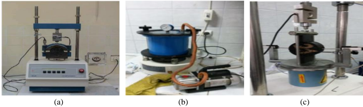
Şekil 3. Marshall stabilite deney cihazı (a), Numunelere vakum uygulanması (b), ITS deney cihazı (c)
