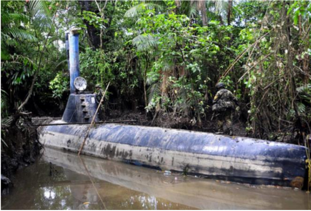
Resim-5. Kolombiya'nın Pasifik Kıyılarına Yakın Tespit Edilen 32 Metre Uzunlukta SPFS Tipi Narko-denizaltı (Molinski, 2011)
