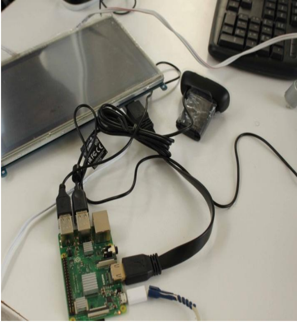
Şekil 4: Prototip çalışmalarından bir görüntü (Raspberry Pi, LCD dokunmatik ekran ve web kamera)
