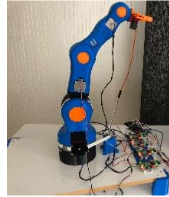
Şekil 1: 5 serbestlik derecesine sahip robotik kol
