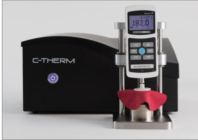
Şekil 2. C-Therm-TCI termal iletkenlik-efüzyon test cihazı
