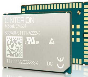
Şekil 1. Cinterion EMS31 IoT kablosuz modülü [4]
