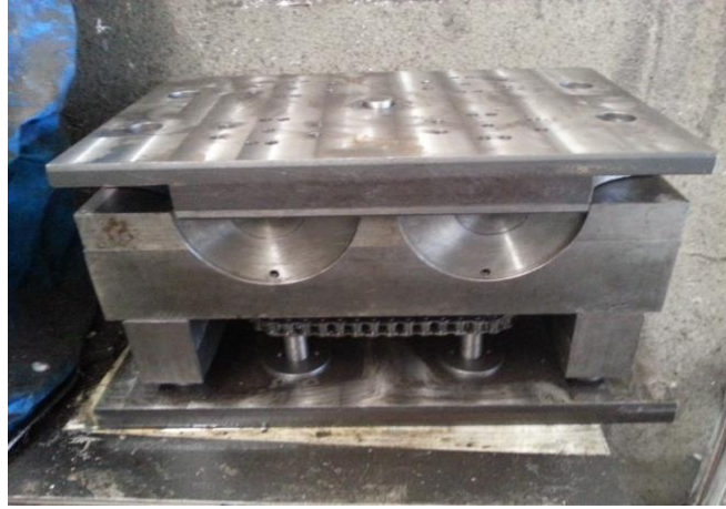
Şekil 13. Çift lokmal kalıp üretimi
