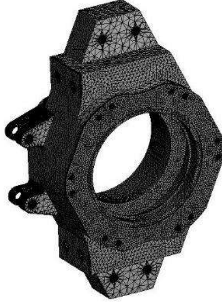
Şekil 7. Taşıyıcı parçasına ait ağ yapısı
