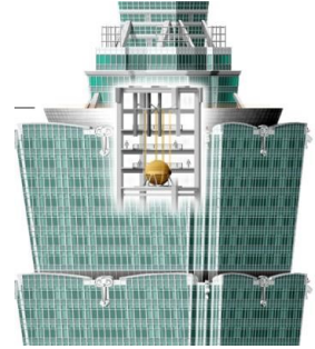
Şekil 6. Taipei 101'deki Sönümleyici [29]
