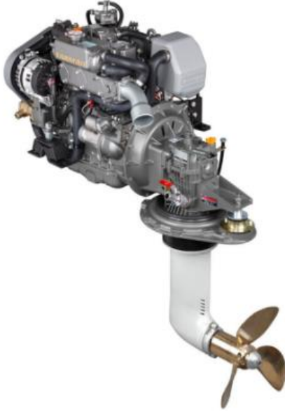
Şekil 6. Moody 41DS teknesinde mevcut dizel motor ve sevk sistemi.
