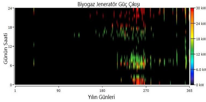
Şekil 8: Sisteme entegre edilen biyogaz jeneratörünün çıkış gücü değerleri.
