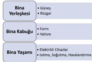
Şekil 1. Binalarda enerji verimliliği önlemleri
