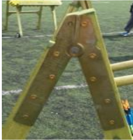
Şekil 1. Hedef ayağı tasarımında kullanılan merdiven makası görüntüsü
