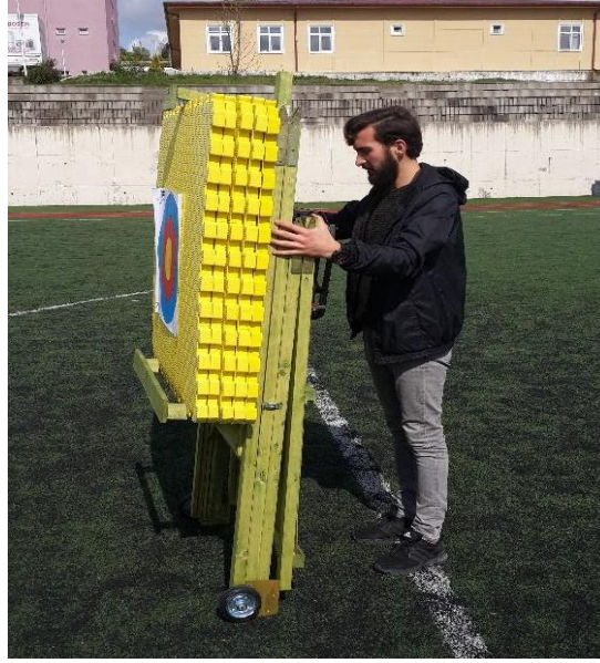
Şekil 8. Ahşap hedef ayağının katlanarak az yer kaplaması
