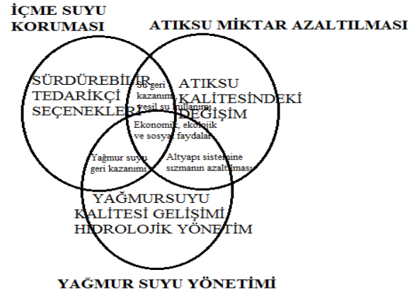
Şekil 1. Bütünleşik Kentsel Su Döngüsü (İçme ve Kullanma Suyu, Yağmur Suları ve Atıksular)
