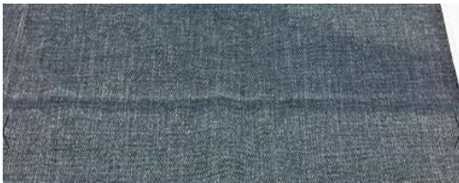
Şekil 8. Floklu kumaşlarda duruş hatası.
