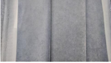
Şekil. 4. Floklu kumaşlarda kanat farkı (kenar-orta-kenar) hatası.
