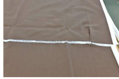
Şekil. 5. Floklu kumaşlarda ek kırışıklık hatası.
