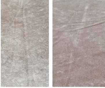
Şekil 7. Floklu kumaşlarda boyuna kırık hatası.
