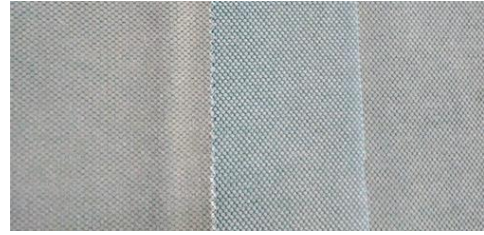
Şekil 2. Floklu kumaşlarda süet abrajı-seyreklik hatası.
