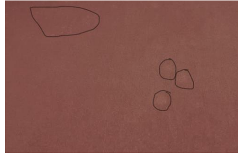
Şekil 1. Floklu kumaşlarda süet abrajı.
