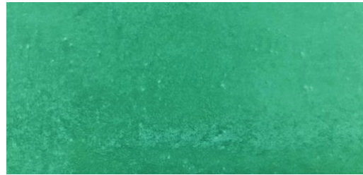
Şekil 3. Floklu kumaşlarda statik leke hatası.
