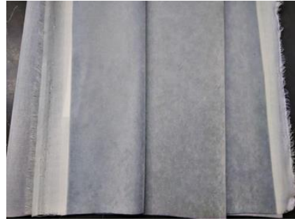
Şekil 9. Floklu kumaşlarda kanat farkı hatası.
