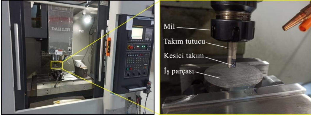
Şekil 1. Deneylerde kullanılan takım tezgahı ve deney düzeneği [19].
