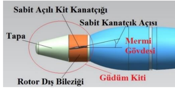
Şekil 4. Öngörülen güdümlü mermi geometrisi.
