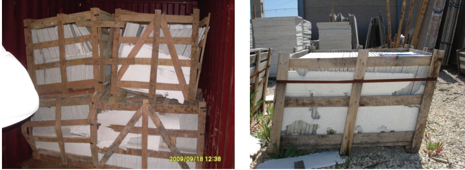
Şekil 4: Hatalı paketleme nedeniyle hasar görmüş ürünler ve hasar görmüş ahşap ambalajlar (Angı, 2012)
