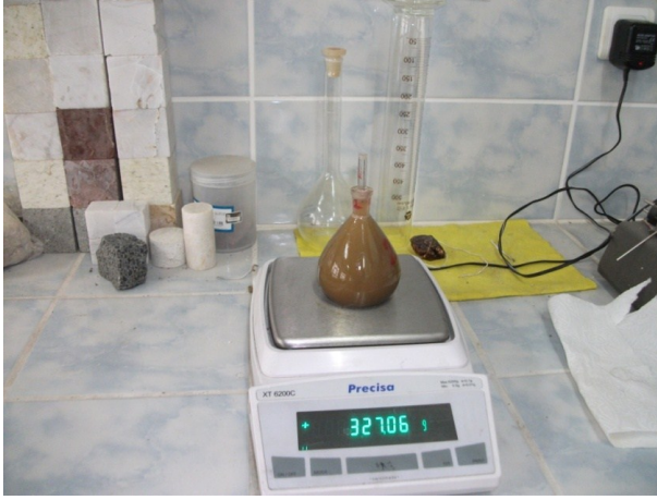
Şekil 21. Piknometre ve hassas terazi
