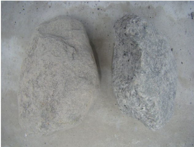
Şekil 2. Aşındırma deneyi sonrası bazalt ve granit.
