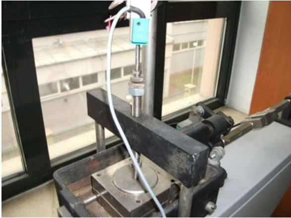
Şekil 15. Numunenin oturma miktarının LVDT ile ölçülmesi
