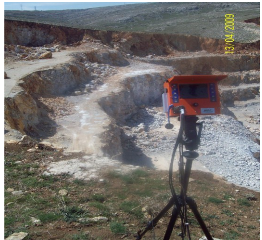
Şekil 3. MREL Blaster Ranger (YHVK)
