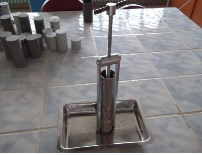
Şekil 26. Sıkıştırılmış tek eksenli basma dayanımı numunesi hazırlama
