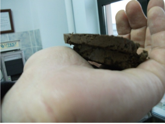
Şekil 2. Kesme kutusunda kırılmış numune
