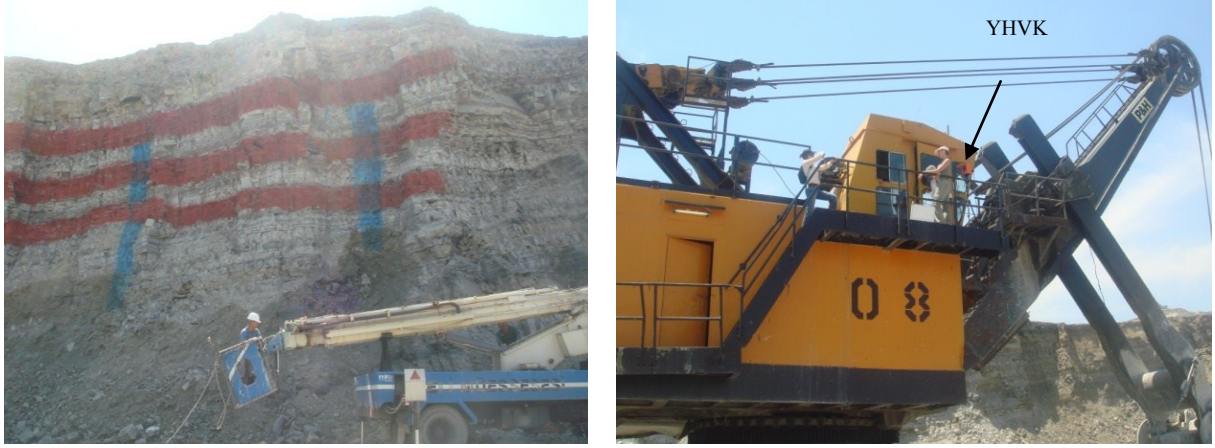
Şekil 14. Aynayı boyama işlemi ve YHVK lokasyonu
