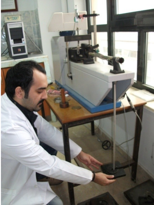
Şekil 23. Konsolidasyon testi için düzeneğe ağırlık takılışı
