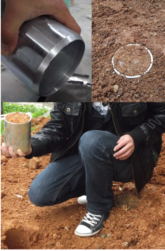
Şekil 24. Permeabilite numune kalıbı ve numune alma
