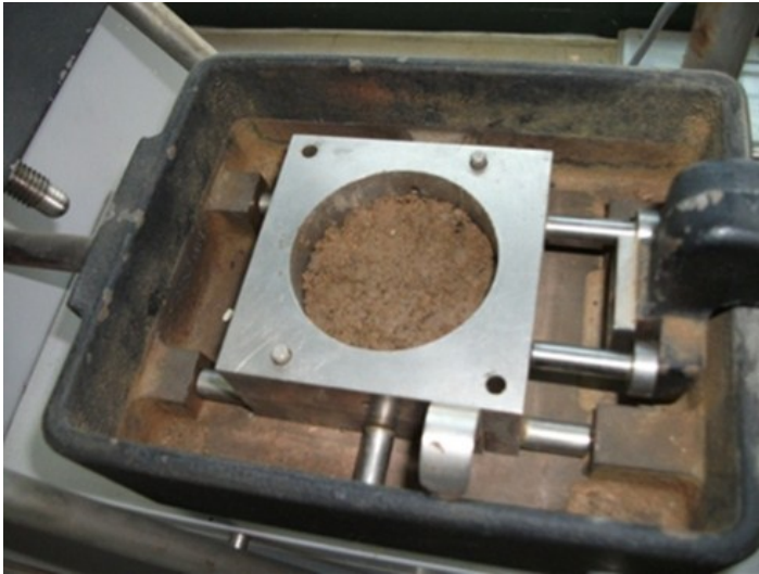
Şekil 1. Kesme kutusuna yerleştirilmiş numune
