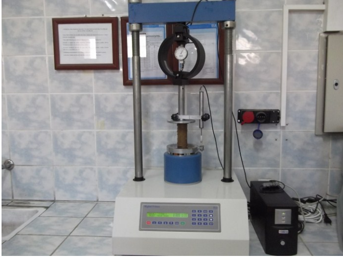
Şekil 28. Tek eksenli basma dayanımı testi
