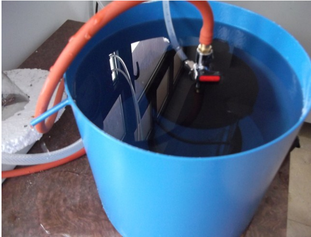
Şekil 25. Islama haznesi içindeki numune kalıbı
