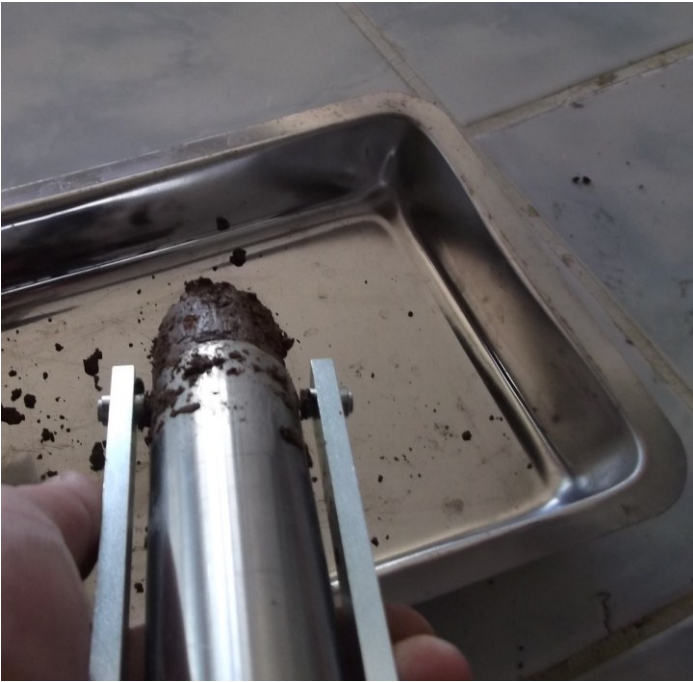
Şekil 27. Hazırlanan numunenin çıkarılması
