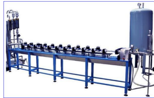
Şekil 7. Laboratuvar ölçekli sayaç test sistemi düzeneği.
