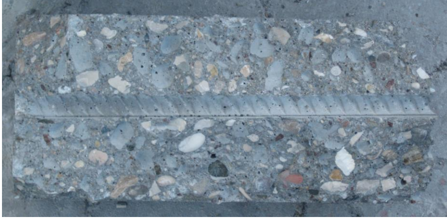
Şekil 3. Pull out deneyi sonrası (donatı sıyrıldıktan sonra) numune kesit görünümü
