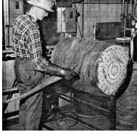
Resim 5. Çelik yün katotlu elektrolitik hücre (Zadra hücresi)
