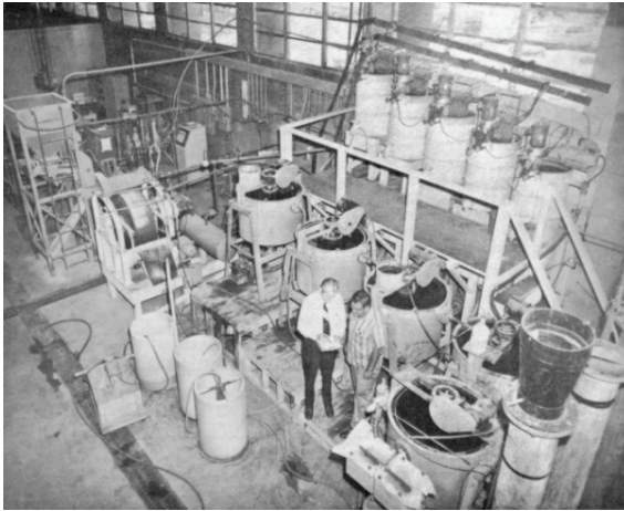
Resim 4. Elektro-oksidadasyon pilot tesisi (A.B.D. Madencilik Bürosu, USBM)
