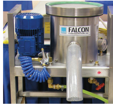
Şekil 1. Laboratuvar ölçekli SB40 model Falcon konsantratörü.
