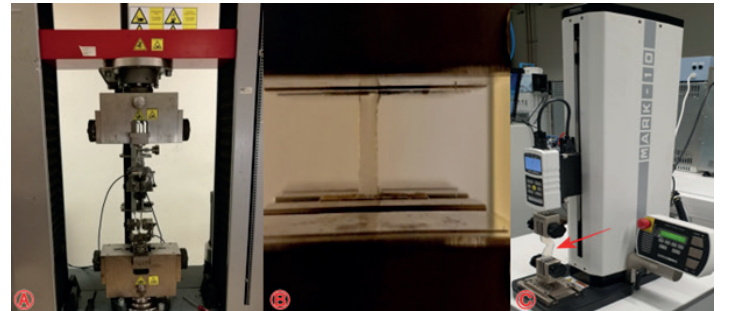
Şekil 5. Laboratuvar testleri ile dokuların mekanik özelliklerinin gerçeklik testi. A ve B: Üniversal test makinası ile çekme testi deney düzeneği. C: Yırtılma mukavemeti ölçümünde kullanılan Mark-10 marka masa üstü Üniversal test makinası ile çekme deney düzeneği.
