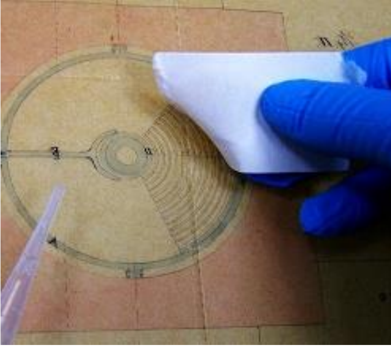
Şekil 7: Mürekkebin akma durumunun test edilmesi.
