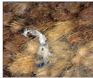
Şekil 14. Uygulama Sonrası USB Mikroskop böcek - yumurta - pupa - larva ve lif hasar görüntüleri. / USB Microscope images of insect - egg - pupa - larva and fiber damage after application.
