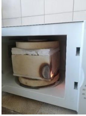
Görsel 3. Hazne 2 deformasyonu (Kişisel arşiv)
