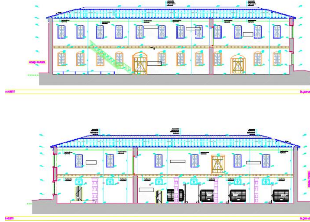
Şekil 3. Tabakhane yapısının restorasyon projesine ilişkin kesitler.
