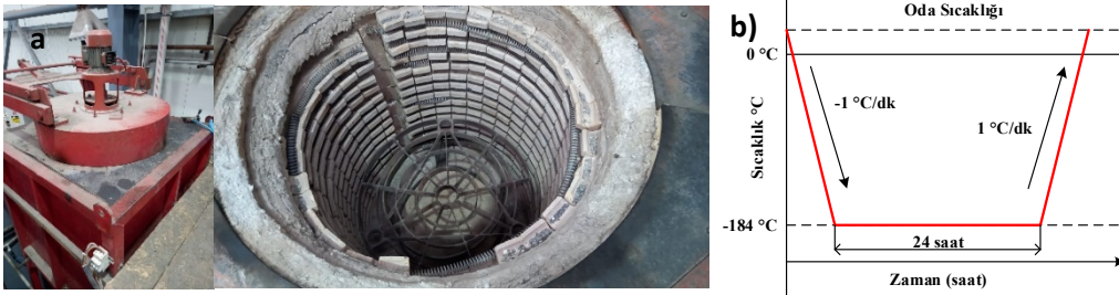
Şekil 3. Pirinç elektrot için; a) kriyojenik işlem kabı, b) Kriyojenik işlem çevrimi.
