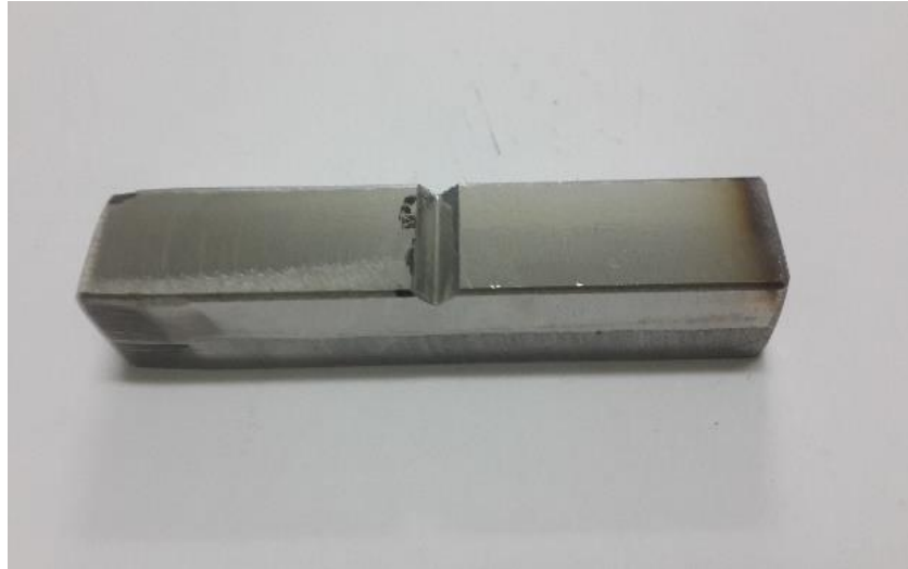
Şekil 2. Charpy darbe test numunesi
