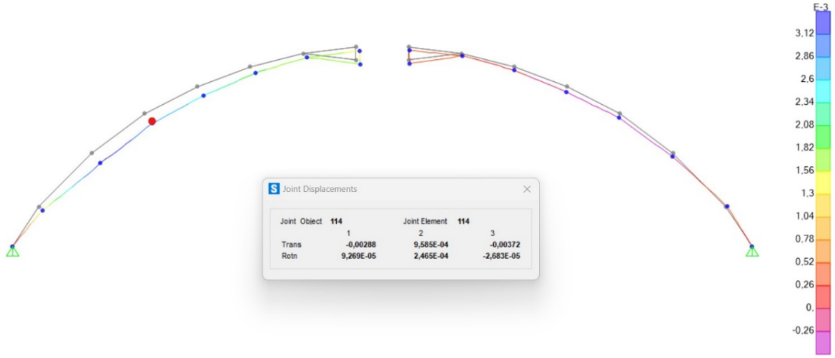
Şekil 10. Düşey yer değiştirme kontrolünün G+0,5Q+W_1 yük kombinasyonu altında deplasmanı [17]
