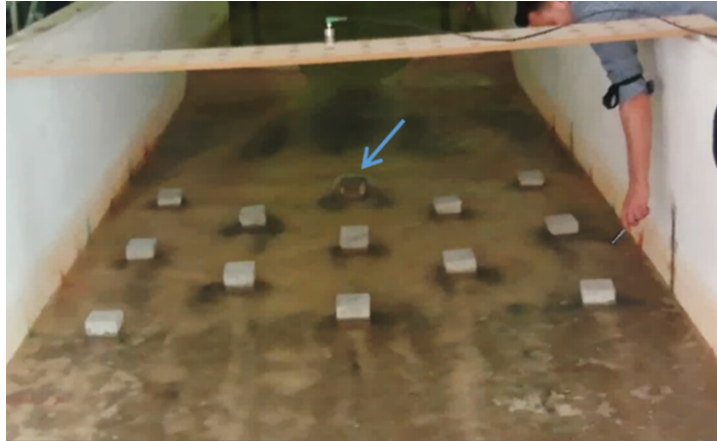
Şekil 8. Pürüzlü deneyde maksimum hidrolik sıçrama
