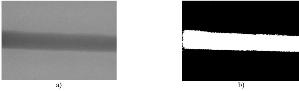
Şekil 3. Otsu eşikleme sonucu a) Orijinal görüntü b) Otsu metodu uygulandıktan sonra oluşan görüntü
