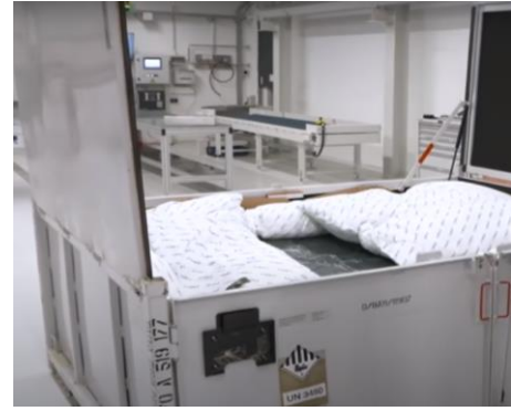
Şekil 2. Bataryaların İkmalî için Kullanılan Güvenlik Kabini (Safety Box) ve Darbe Emici Unsurlar (Volkswagen Group)
