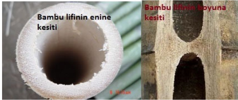
Şekil 1. Bambu lifinin boyuna ve enine kesiti [3].
