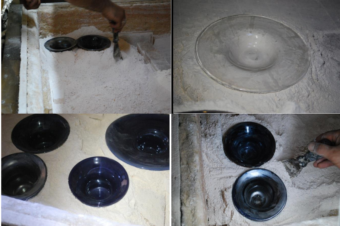
Şekil 5. Lüsterli camların fırınlama aşaması.
