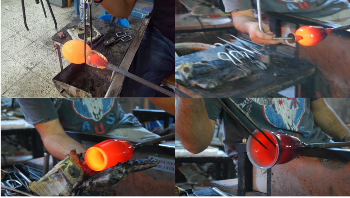
Şekil 3. Cam ürünlerin şekillendirme aşamaları.
