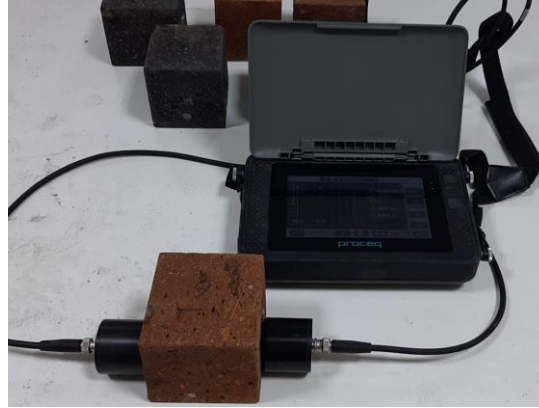
Şekil 5. Ultrases hızı deneyi ve dinamik elastisite modülü ölçümü
