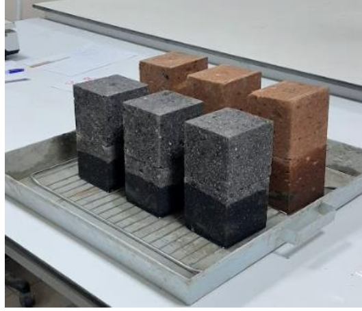
Şekil 6. Kılcal su emme deneyi
