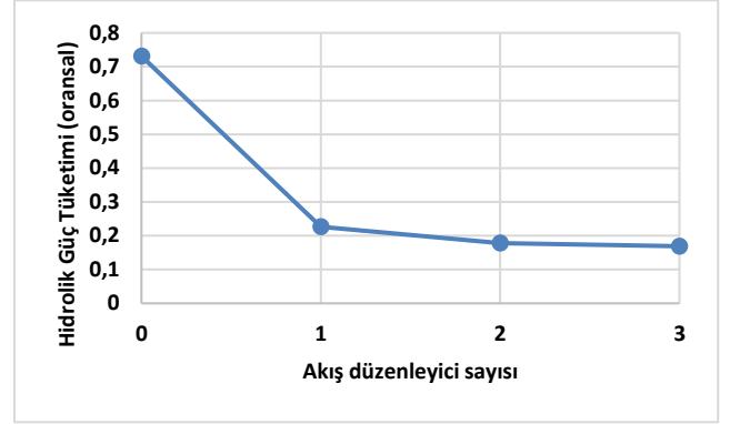
Şekil 11. U/G=10 için akış düzenleyicilerin hidrolik güç tüketimine etkisi.
