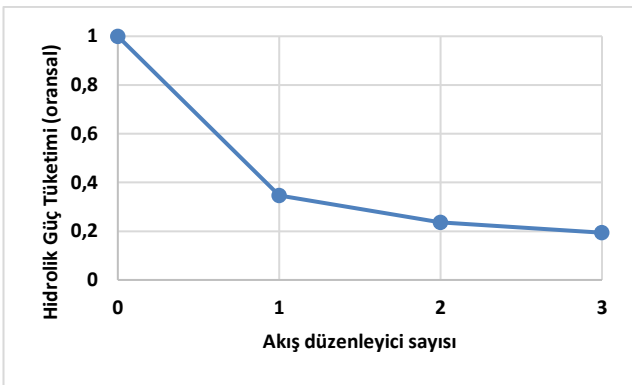
Şekil 10. U/G=5 için akış düzenleyicilerin hidrolik güç tüketimine etkisi.
