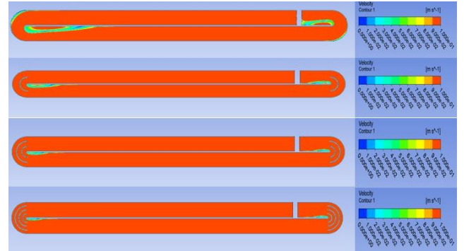
Şekil 12. U/G=10 için 0,1,2 ve 3 akış düzenleyici eklenmiş havuzun ölü bölgeleri.
