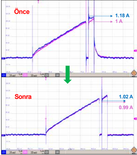
Şekil 22: Önerilen algoritma ile akım paylaşımının değişimi
