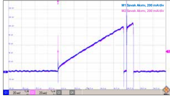
Şekil 20: Önerilen algoritma devreye girdikten sonra MOSFET’ler arasındaki akım paylaşımı
