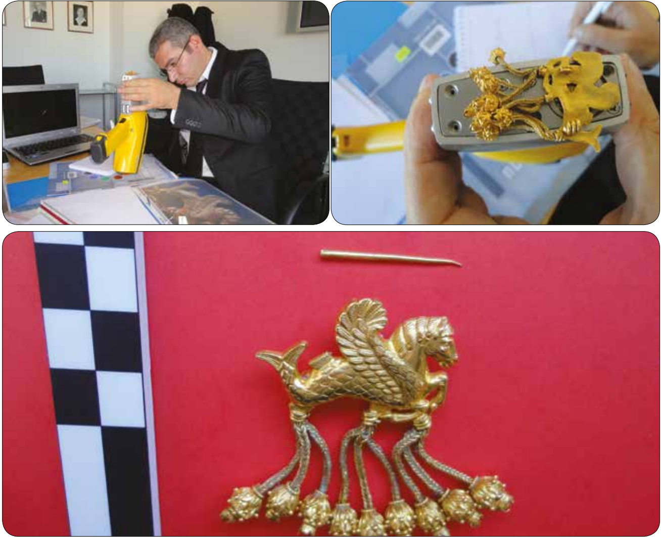
Şekil 4 a-c: Almanya Hagen'de Altın Kanatlı Denizatı Üzerinde P-XRF Analiz Çalışması ve Eser Detayları / P-XRF Works on Golden Winged Seahorse that Captured in Hagen-Germany and Details of the Object (Mahmut Aydın)
