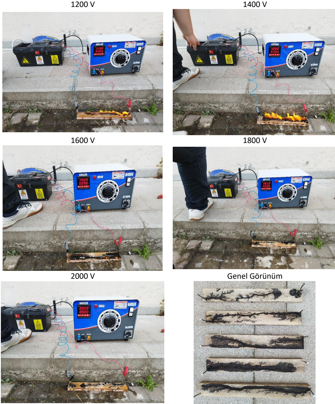
Şekil 3. Çamaşır sodası ile yakmada elde edilen bulgular
