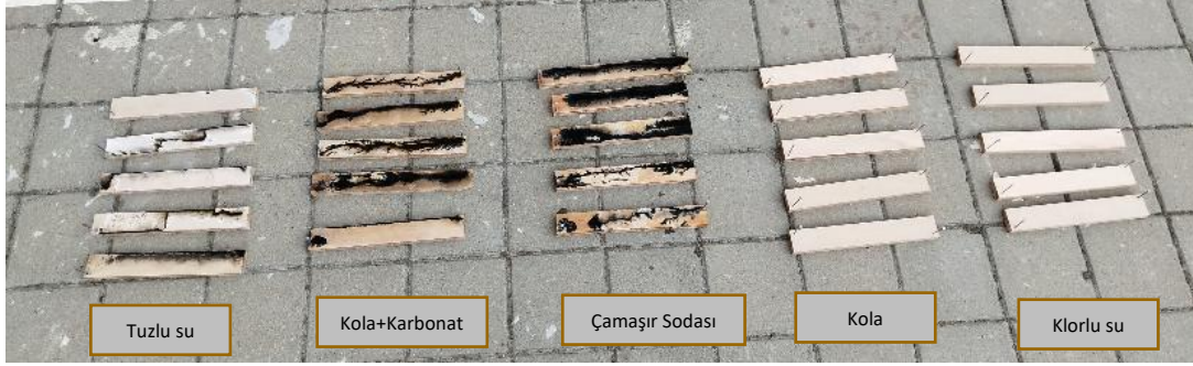
Şekil 5. Yüksek voltaj ahşap yakma işlemi sonuçları
