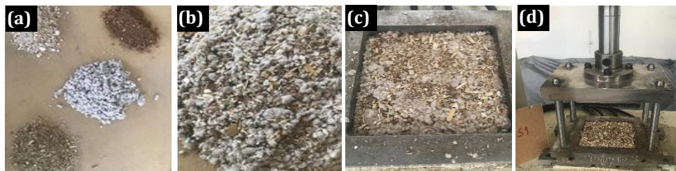
Şekil 6. 2. Grup numune hazırlama (a) numune hazırlama, (b) numune karışımı, (c) kalıba yerleştirme, (d) presleme.
