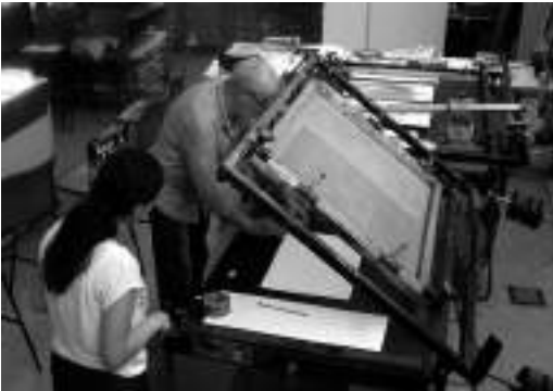
Görsel 32. Hazır eleğin tezgâhta sabitlenmesi Bristol, İngiltere: University of West England, Dave Fortune Baskı Atölyesi.
