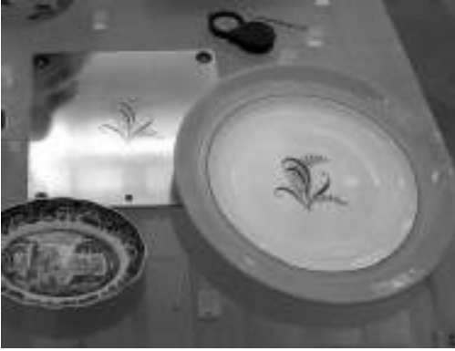
Görsel 21. Porselen Tabak Üzerinde Murray Curvex Yöntemiyle Yapılmış Desen ve Metal Kalıbı Londra, İngiltere:Victoria and Albert Museum, Fotoğraf: Ezgi Martinez.
