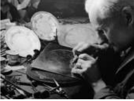
Görsel 8. Metal plaka üzerinde büyüteç altında çalışan gravürcü.
