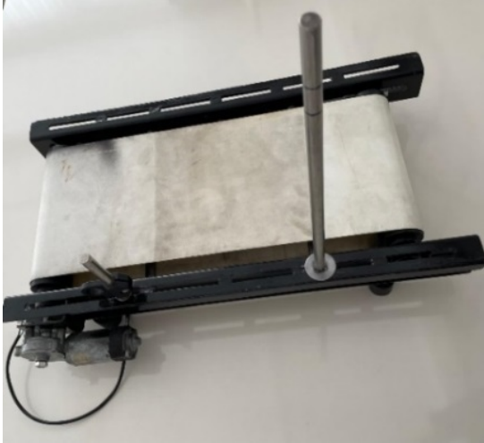
Şekil 3 Konveyör Bant Sistemi (Conveyor Belt System)
