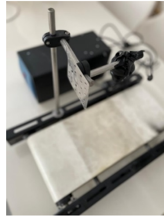
Şekil 2 Konveyör Bandında Kameranın Konumu (Camera Position on Conveyor Belt)
