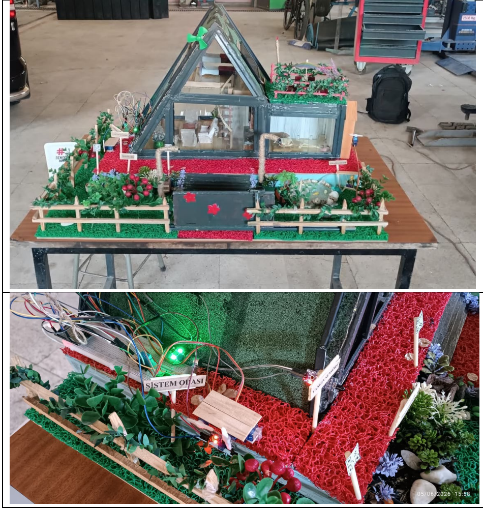
Şekil 7. Prototip sistem odası ve ESP32 tabanlı veri işleme düzeneği.
