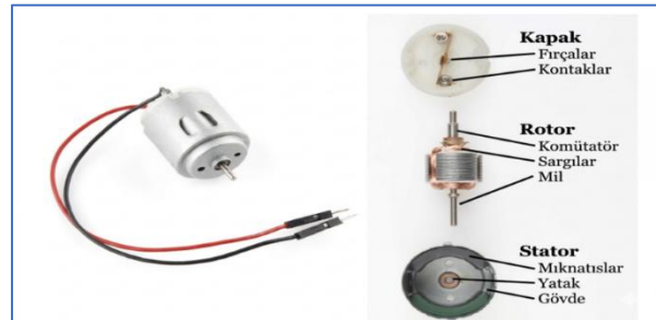
Şekil 1. F.A.I.R. veri seti çalışmasında kullanılan FDA motorunun temel bileşenleri: Armatür, sargılar, fırçalar, komütatör ve stator mıknatısları (Reñones, 2020).
