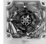
Şekil 2.7. Rüzgar yön duyargasının iç yapısı
