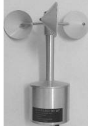
Şekil 2.6. Rüzgar hız duyargası
