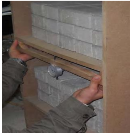
Şekil 9. Komparatörler ile sehim ölçümlerin yapılması (mm).
